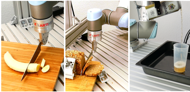
Abbildung 10 Schneiden und Ausgießen mit einem Universal Robots UR5
